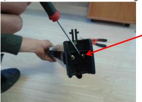
Placé l'intérieur de la barre de charge vers vous et retirez la vis placée vers l'extérieur, renouvelez l'opération pour l'autre embout.
