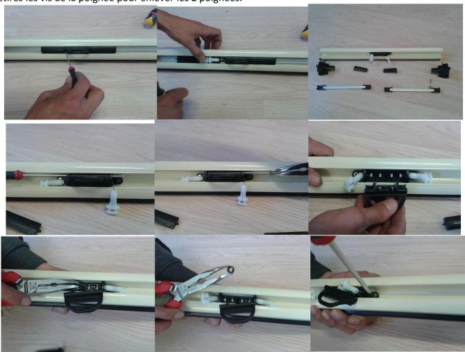
6/ Commencer par replacer la poignée intérieur : la faire glisser le long de la barre de charge avec le repère vers le haut. Insérer l'axe du mécanisme de la poignée extérieure, remettre la goupille.
